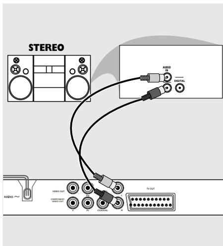
El sistema estéreo tiene entradas de Dolby Pro Logic o entradas derecha/izquierda de audio
