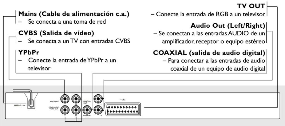
**Precaución:** No toque los contactos internos de los conectores del panel posterior. Una descarga electrostática podría ocasionar daños irreparables en la unidad.
