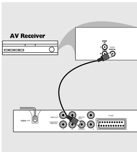
El receptor tiene un decodificador PCM, Dolby Digital o MPEG2
