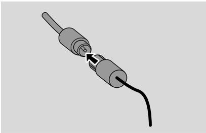
**Nota:** Se estiver a utilizar um sistema de antena por cabo ou uma antena exterior, ligue a respectiva ficha a FM ANTENNA, em vez da antena de fio.
