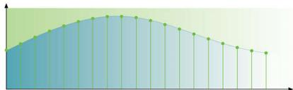
Частота дискретизации 192 кГц позволяет получать точную копию исходной АЧХ. Совместно с 24-х битным разрешением обеспечивается захват большего количества информации из аналогового аудиосигнала оригинала, что в конечном итоге приводит к более богатому воспроизведению звука.
