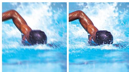
Функция прогрессивной развертки удваивает разрешение изображения по вертикали, что выражается в заметно более четком изображении. Вместо передачи на экран сначала поля с нечетным числом строк, а затем поля с четным числом строк,
