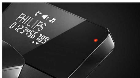
Красный светодиодный индикатор, удобно расположенный на дисплее, мигает, сообщая о пропущенных вызовах. Благодаря интеллектуальной функции CallLog одним нажатием кнопки можно узнать, чей звонок вы пропустили.
