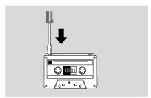
Wenn die Meldung "EHEEK TRPE" angezeigt wird, wurde die Überspielschutzlasche herausgebrochen. In diesem Fall die Öffnung mit einem Stück Klebeband zukleben.
