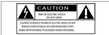
Ce symbole éclair signifie que les composants non isolés de votre appareil peuvent provoquer une décharge électrique. Pour la sécurité de votre équipement, ne retirez pas le couvercle du produit.
