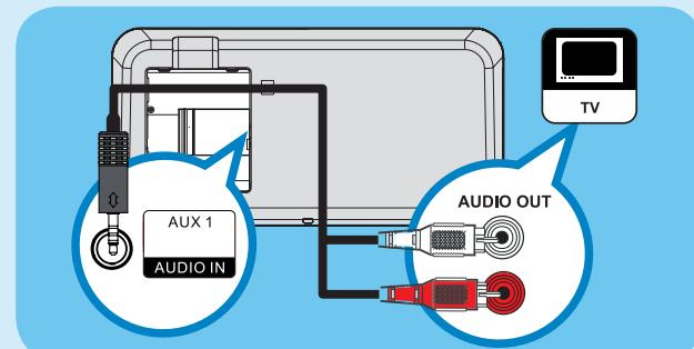
**Not** Ses çıkışını bu bağlantılardan almak için, **AUX/DI / MP3 LINK** görüntülenene kadar, gösterge panelindeki 'AUX1 INPUT' düğmesine arka arkaya basın.
