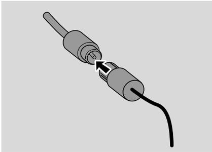
**Remarque :** Si vous utilisez un système d'antenne par câble ou une antenne extérieure, insérez la fiche de l'antenne dans FM ANTENNA à la place de l'antenne filaire.
