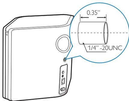
Attraverso questo foro, è possibile montare facilmente il dispositivo a parete con una staffa per montaggio idonea. La staffa per montaggio non è inclusa ed è necessario acquistarne una. Seguire le istruzioni incluse con la staffa per montaggio a parete acquistata.
