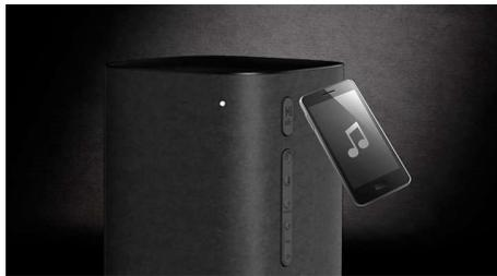
Empareja dispositivos Bluetooth® fácilmente con la tecnología de un toque NFC (comunicaciones por proximidad). Solo tienes que tocar con el smartphone o la tableta con NFC la zona NFC del SoundStage para encenderlo, iniciar el emparejamiento a través de Bluetooth® y comenzar a transmitir música.
