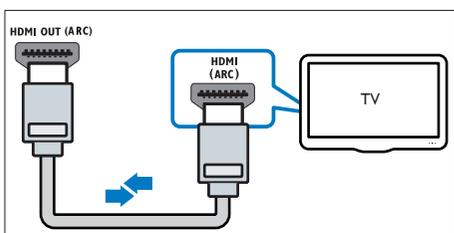
1 Utilizando um cabo HDMI de alta velocidade, ligue o conector **HDMI OUT (ARC)** no seu sistema de cinema em casa ao conector **HDMI ARC** no televisor:
