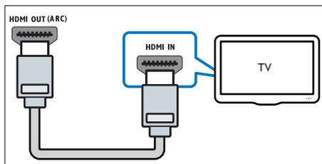
1 Utilizando um cabo HDMI de alta velocidade, ligue o conector **HDMI OUT (ARC)** no seu sistema de cinema em casa ao conector **HDMI IN** no televisor:
