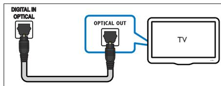
1 Utilizando um cabo óptico, ligue o conector **DIGITAL IN-OPTICAL** no seu sistema de cinema em casa ao conector **OPTICAL OUT** no seu televisor ou noutro dispositivo.
