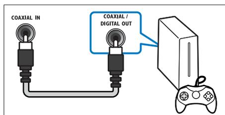
1 Utilizando um cabo coaxial, ligue o conector **COAXIAL IN** no seu sistema de cinema em casa ao conector **COAXIAL/ DIGITAL OUT** no seu televisor ou noutro dispositivo.
