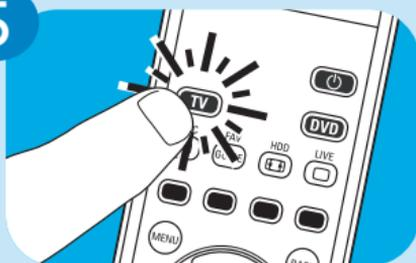
Удерживайте кнопку выбора устройства нажатой в течение 5 секунд для выхода из режима настройки и сохранения параметров.
