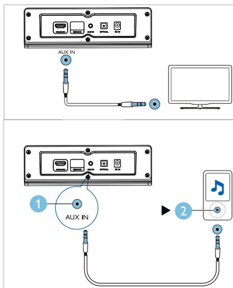
Pomoću audio kabela od 3,5 mm, spojite priključak **AUX IN** na vaš soundbar zvučnik na priključak **AUX** na televizoru ili drugom uređaju.
