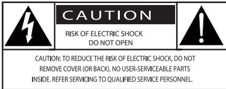
Ce symbole éclair signifie que les composants non isolés de votre appareil peuvent provoquer une décharge électrique. Pour la sécurité de votre entourage, ne retirez pas le couvercle du produit.
