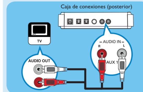
**Nota:** Para escuchar la salida de audio a través de esta conexión, pulse **AUX/DI/MP3 LINK** varias veces hasta que aparezca "AUX1 INPUT" (entrada auxiliar 1) en el panel de visualización.
