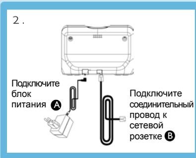
3. Подключите другой конец соединительного провода к телефонной розетке, а адаптер источника питания к электрической розетке.
