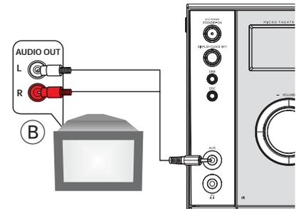
B Um den Ton Ihres Fernsehgeräts über diesen DVD-Player wiederzugeben, verbinden Sie mithilfe eines Cinch-Kabels (nicht mitgeliefert) die Buchse **AUX** auf der Vorderseite des DVD-Players mit den entsprechenden **AUDIO OUT**-Buchsen am Fernsehgerät.
