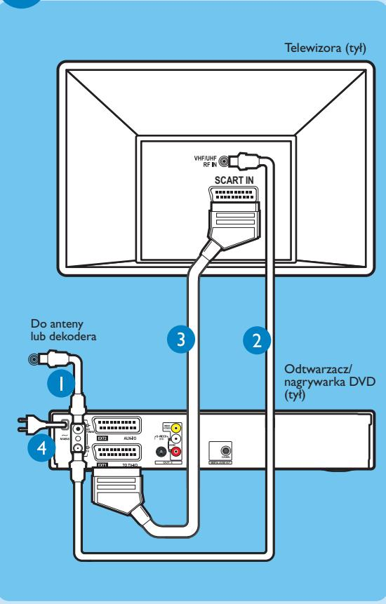
1 Podłącz przewód antenowy do gniazda **ANTENNA** nagrywarki.
