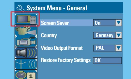
**UWAGA** Za pomocą przycisków **CH+** i **CH-** można przelaczać aktywne opcje. Naciśnij przycisk **OK**, aby wybrać daną opcję. Aby zatwierdzić wybór ustawienia, naciśnij przycisk **OK**.
