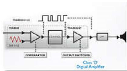
Amplification puissante et encombrement réduit ! L'amplificateur numérique de classe D convertit un signal analogique en signal numérique, puis l'amplifie numériquement. Ce signal traverse ensuite un filtre de démodulation avant d'atteindre la sortie finale. La sortie numérique amplifiée offre tous les avantages de l'audio numérique, par-dessus tout une meilleure qualité de son. De plus, l'amplificateur de classe D génère plus de 90 % d'efficacité par rapport aux amplificateurs traditionnels AB.
