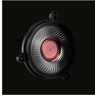
I driver LMC (Layered Motion Control) sono dotati di un diaframma a polimeri multistrato che racchiude uno strato di gel. Questi strati formano una barriera flessibile e, insieme al gel, assorbono e riducono le frequenze troppo alte, offrendo una risposta in frequenza più fluida e costante. In questo modo si ottengono frequenze alte più bilanciate, naturali e dall'audio migliore.
