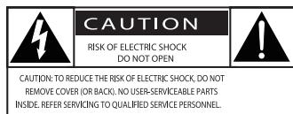
Значок молнии указывает на наличие неизолированных материалов в устройстве и опасность поражения электрическим током. В целях безопасности не снимайте корпус. Восклицательный знак указывает на функции, перед использованием которых необходимо внимательно ознакомиться с прилагаемым руководством во избежание последующих проблем с работой и обслуживанием устройства.
