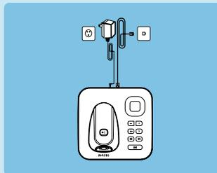
2. Collegare il cavo telefonico e quello dell'alimentatore ai propri connettori corrispondenti posizionati nella parte posteriore della base.
