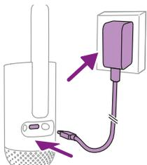
Priključite adapter za napajanje u kameru za dijete i zidnu utičnicu.
