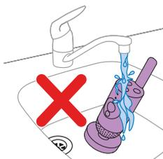
**Upozorenje:** nemojte uranjati kameru za dijete i adapter za napajanje u vodu i nemojte ih čistiti pod mlazom vode iz slavine.
