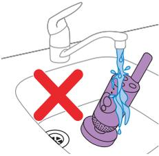
**Warnhinweis: Tauchen Sie die Babykamera und das Netzteil nicht in Wasser ein, und reinigen Sie sie auch nicht unter fließendem Wasser.**
