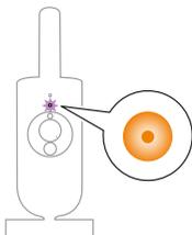
2 Blinker oransje: babykameraet oppgraderer fastvaren. Ikke slå den av under oppgraderingen.
