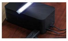
Utilisez les 2 ports HDMI 2.0 et un port USB-A pour connecter tous vos appareils.
