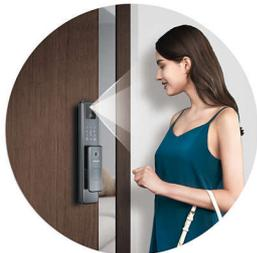
飞利浦 DDL301-FVP-7HW 运用多普勒雷达感应原理, 当人靠近门锁 0.9 米 \* 范围内时, 会触发雷达传感器并唤醒人脸识别模块, 前面板的双摄像头模拟人眼成像, 智能捕捉人脸三维立体特征, 验证成功后锁舌将自动回缩, 实现刷脸即开。
