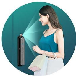
无需多余操作刷脸即开，正是 DDL708-FVP-7HW 的便捷所在。搭载超声波传感器 \*，当您靠近门锁 1 米范围内，即刻唤醒人脸识别模块，双摄像头模拟人眼成像，智能捕捉人脸三维立体特征，还能有效辨别图片、影像、化妆等情况。
