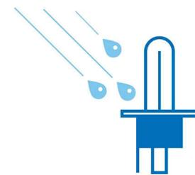
Лише лампа розжарювання, виготовлена з кварцового скла (нитка розжарювання 2650 °C, скло 800 °C), може витримувати різкі температурні стрибки, наприклад, коли крапля холодної води потрапить на гарячу лампу, що може статися під час подолання водної перешкоди з несправним блоком передньої фари.
