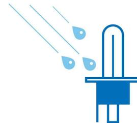
Somente uma lâmpada feita de vidro de quartzo (filamento 2650 °C, vidro 800 °C) pode resistir a choques térmicos. Isso pode acontecer quando uma gota de água gelada toca a lâmpada quente, comum quando se dirige na chuva com um farol quebrado ou com problema de vedação.
