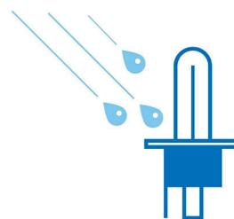
Лише лампа розжарювання, виготовлена з кварцевого скла (нитка розжарювання 2650 °C, скло 800 °C), може витримувати різні температурні стрибки, наприклад, коли крапля холодної води потрапить на гарячу лампу, що може статися під час подолання водної перешкоди з несправним блоком передньої фари.
