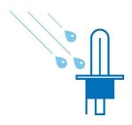
熱温度衝撃には、石英ガラス(フィラメント 2650 ℃、ガラス 800 ℃)でできたバルブのみが耐えられます。熱温度衝撃は、熱くなった電球に 1 滴の冷水が落ちた場合などに発生します。ヘッドライト部分が壊れた状態で雨の中を走行したときに、起こりえる状況です。
