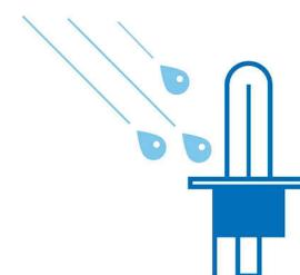
熱温度衝撃には、石英ガラス（フィラメント 2650 °C、ガラス 800 °C）でできたバルブのみが耐えられます。熱温度衝撃は、熱くなった電球に 1 滴の冷水が落ちた場合などに発生します。ヘッドライト部分が壊れた状態で雨の中を走行したときに、起りこえる状況です。
