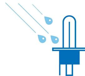
Chỉ bóng đèn đốt cháy làm bằng thủy tinh thạch anh (sợi đốt ở 2650°C, thủy tinh ở 800°C) mới có thể chịu được những cú sốc nhiệt cao: chẳng hạn như một giọt nước lạnh chạm vào bóng đèn đang nóng, khi bạn lái xe qua bề mặt có nước với một bộ phận đèn pha bị vỡ. Ứng dụng khác nhau trên từng loại bóng đèn
