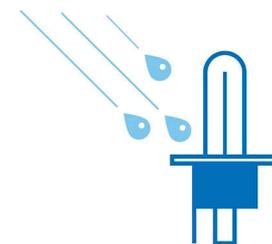
熱温度衝撃には、石英ガラスでできたバルブ (フィラメント 2650 °C、ガラス 800 °C) のみが耐えられます。熱温度衝撃は、熱くなった電球に 1 滴の冷水が落ちた場合などに発生します。ヘッドライト部分が壊れた状態で雨の中を走行したときに、起こりえる状況です。
