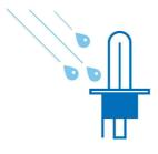
灯泡点亮时,只有石英玻璃制成的灯泡 (灯丝 2650°C,玻璃 800°C)才能抵抗 热冲击:如果一滴冷水接触到热灯泡会发 生什么? 当您带着破损的车头灯具驶过水塘时就可能发生这种情况。
