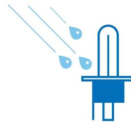
มีเพียงหลอดไฟที่ทำจากแก้วครอบซัลโภพ (ไส้หลอด 2650 °C และแก้ว 800 °C) ที่สามารถทนต่อการเปลี่ยนแปลงอุณหภูมิกันที่ทนได้ดี : เช่น ถ้าเมียดนาเย็นตกรอบหลอดไฟที่กำลังร้อน ชื้นอาจเกิดขึ้นได้ เมื่อคุณขับผ่านน้ำข้างถนนไฟน้ำที่บ้ารุดอยู่ ^ การใช้งานแตกต่างกันไปตามประเภทหลอดไฟ
