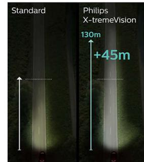
Оптимізована високоточна геометрія нитки розжарювання, заповнення газом під високим тиском до 13 бар, високоточне покриття та високоякісне кварцове скло з захистом від УФ променів – лампи для передніх фар Philips X-tremeVision визначають новий стандарт у галузі автомобільного освітлення. Ці лампи створено для максимальної видимості та ефективності.
