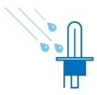
Somente uma lâmpada feita de vidro de quartzo (filamento 2650 °C, vidro 800 °C) pode resistir a choques térmicos. Isso pode acontecer quando uma gota de água gelada toca a lâmpada quente, comum quando se dirige na chuva com um farol quebrado ou com problema de vedação.
