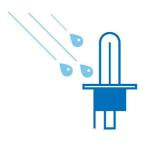
Solo una bombilla encendida fabricada con cristal de cuarzo (filamento a 2 650 °C, cristal a 800 °C) puede soportar cambios bruscos de temperatura; por ejemplo, soporta sin explotar el goteo de agua fría sobre el cristal caliente de la lámpara, algo que puede suceder al conducir con una lámpara delantera rota y si hay agua en el entorno.
