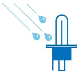
Solo una lámpara encendida fabricada con cristal de cuarzo (filamento a 2.650 °C, cristal a 800 °C) puede soportar cambios bruscos de temperatura; por ejemplo, soporta sin explotar el goteo de agua fría sobre el cristal caliente de la lámpara, algo que puede suceder al conducir con una lámpara delantera rota y si hay agua en el entorno.
