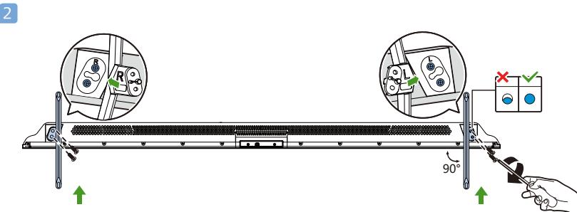
\*底座左右不防反，正确安装后底座与屏幕垂直（如上图所示），再按照图示将螺丝锁紧。
