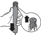
7. 充電電池をハンドル内部部品から引き出し、もう一方の充電電池タブを壊します。
