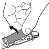
5. 充電電池と内部部品の底の黒い枠との間にマイナスドライバーの先を入れ、こじ開けて充電電池を離し、黒い枠を壊します。
