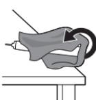
3. 片手でハンドルの上部を持ち、ハンドルの底から約1.5cmの位置をハンマーで叩きます。ハンドルを回転させながら、四方方向から強く叩いて底のキャップを外します。
