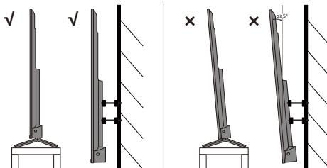
支持的电视机安装托架
