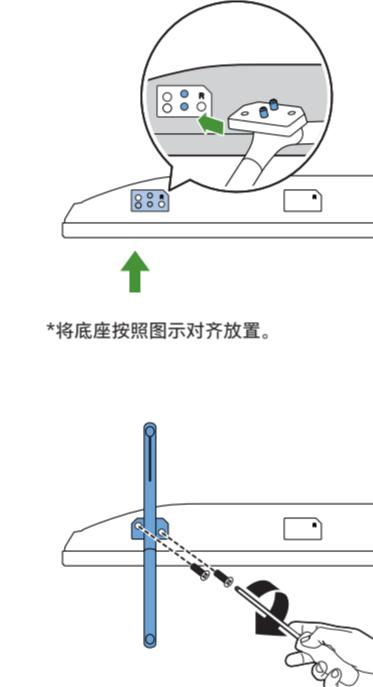
\*将电视底部边缘靠近台面边缘，将下巴放置于台面外约5cm。
