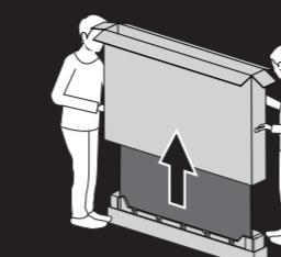
3 两人协作，轻扶机器两侧，从背面托住机器底部竖直抬机。
