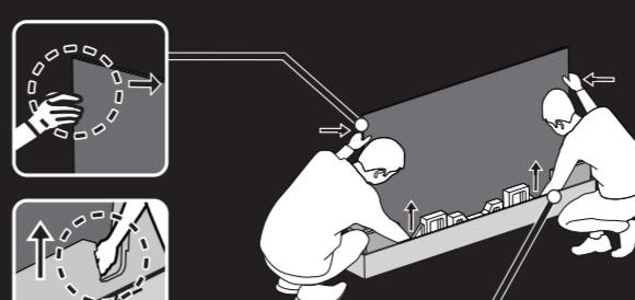
4 竖直移动屏幕，确保平整台面上无杂物后铺上软布，屏幕朝下平放在桌上。
