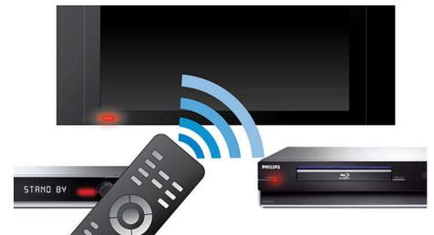
EasyLink utilise le protocole HDMI CEC, une norme de l'industrie permettant de partager les fonctionnalités entre les périphériques connectés et le téléviseur. Avec Easylink, une seule télécommande suffit pour exécuter les principales fonctionnalités de votre téléviseur et des périphériques connectés. EasyLink utilise le câble standard HDMI pour transférer les commandes du système. Ce système fonctionne avec tous les périphériques électroniques compatibles HDMI CEC.
