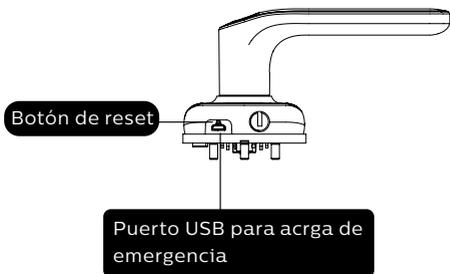
Cuando el voltaje de la batería es bajo y la puerta no se puede abrir desde afuera, puedes encender la cerradura utilizando el puerto micro USB. Después de abrir la puerta, por favor Reemplace las baterías de inmediato. Si el sistema falla y la puerta no se puede desbloquear desde el exterior, por favor presione y suelte el botón de reinicio para reiniciar el sistema.
