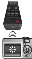
Con una cámara Digital (incluyendo cámaras de teléfono celular integradas): Apunte la cámara Digital hacia el diodo infrarrojo del control remoto en el frente del control remoto. Presione cualquier botón del mando a distancia y observe el visor de la cámara digital. Si la luz infrarroja pulsátil aparece en la cámara, el mando a distancia está emitiendo una señal IR.
