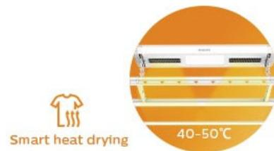
两台贯流风机通过智能温控加热器持续吹出 40-50°C 暖风, 将晾架内径空间营造为一个干房场景, 促使内外的湿冷、干热气流进行循环交换, 确保温度稳定性并快速带走水分, 即使在潮湿天气也能快速干衣。
