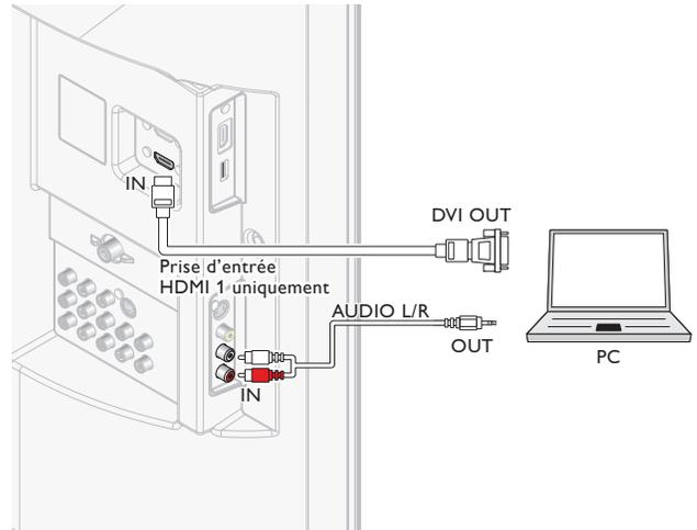
Raccordement d'un PC à l'aide d'un connecteur HDMI
